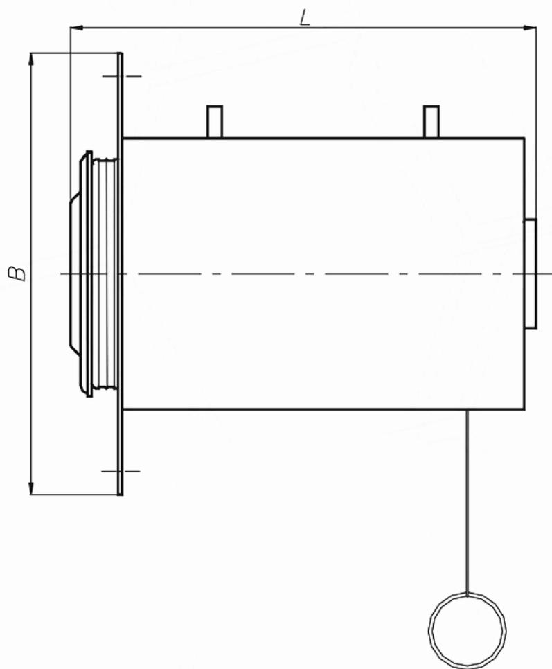
Общий вид генератора пены средней кратности стационарного ГПСС
