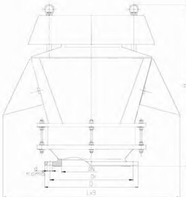
Общий вид клапана дыхательного механического КДМ-200
