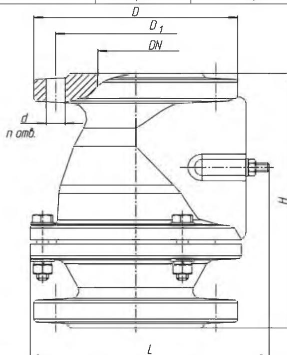
Общий вид клапана дыхательного закрытого типа КДЗТ-50А
