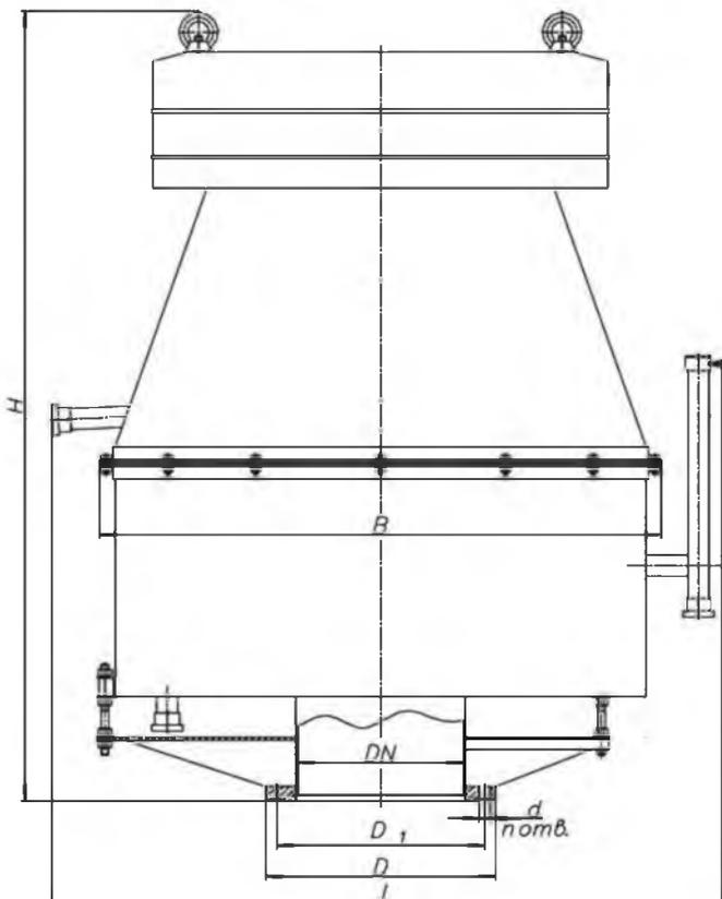
Общий вид клапана предохранительного гидравлического КПГ
